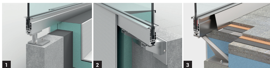
BU 1: Montageblock „Boden“ zur Aufständigung von VISIOPLAN 50 Basisprofilen bei gedämmter Attika
