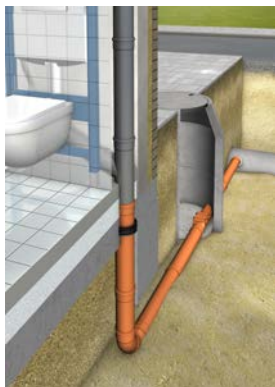
Abb.1: HKD KG-Bodenelement bei Gebäuden ohne Keller
