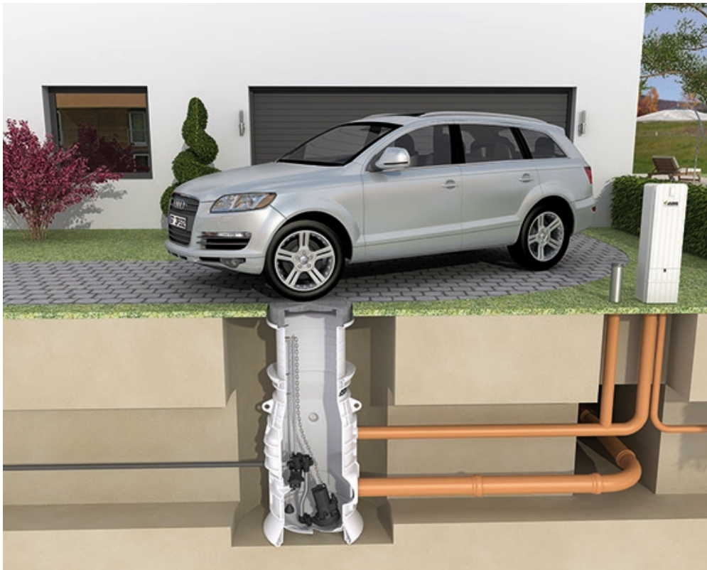
Bild 2: Eine Pumpstation in der Druckentwässerung: Das Schneidsystem der Pumpe sorgt dafür, dass Feststoffe zerkleinert und mit dem Abwasser über klein dimensionierte Druckleitungen entsorgt werden können.
