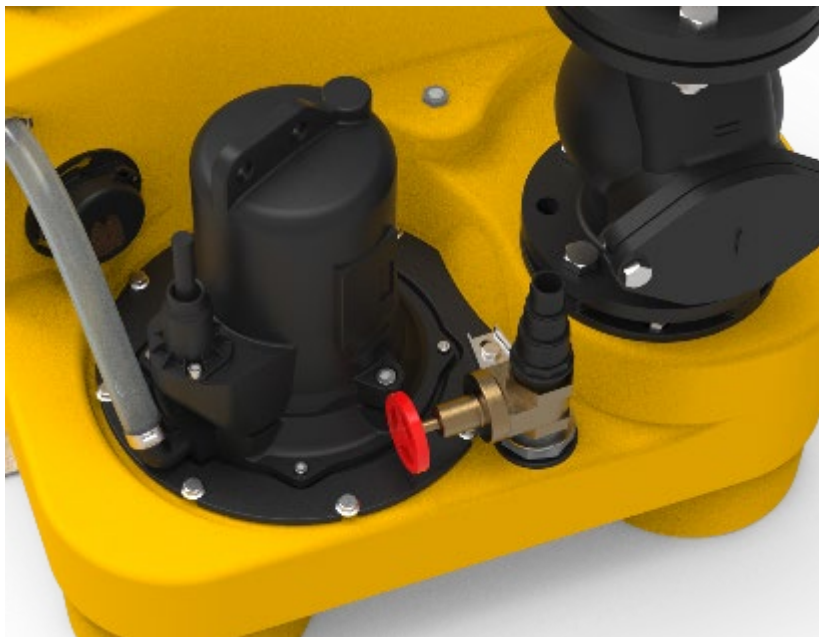
Bild 3) Compli 400: Mit dem im Zubehör erhältlichen Notentleerungsventil kann der Behälter bei Bedarf mittels Nasssauger oder Handmembranpumpe entleert werden.
