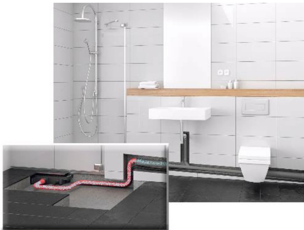
Abb 2b: Nachher: Wird der Duschboden auf das Fußbodenniveau abgesenkt, liegt das alte Abwasserrohr in der Wand oft zu hoch und das Wasser kann nicht abfließen. Hier hilft die Bodenablaufpumpe Plancofix Connect, die das Abwasser sehr leise in das vorhandene Abwasserrohr pumpt. (Bild: Jung Pumpen GmbH)
