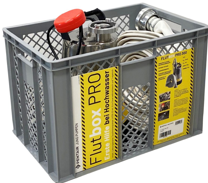
Bild 1: Die Flutbox Pro 300 ist ein professionelles Erste-Hilfe-Set zur Beseitigung von Überschwemmungen aus Tiefgaragen oder anderen größeren Untergeschossen. Sie besteht aus einer stabilen Transportbox, einer leistungsstarken Schmutzwasserpumpe (28 m³/h) und einem 15 m langen Feuerwehrschauch (Ø 52 mm, mit Storz-C-Kupplung).
